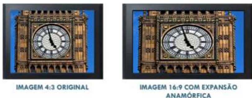
Figura 7: Upconversion Errado : Imagem convertida de 4:3 para 16:9 com Efeito de Expansão Anamórfica ou Efeito de Tela Esticada.
